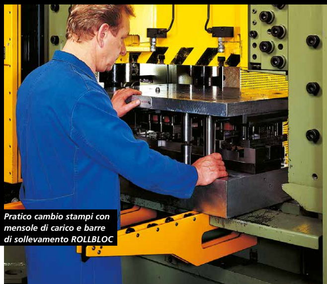
Trasferimento veloce e sicuro tra ROLLBLOC-BUGGY e il tavolo pressa equipaggiato con barre di sollevamento ROLLBLOC
