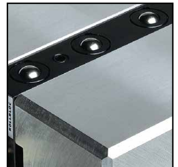
La tavola pressa è attrezzata con inserti di sollevamento ROLLBLOC durante l'utilizzo delle sottopiastre.
