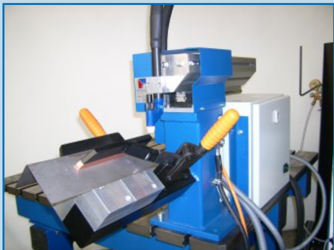
saldatura meccanizzata con giunti longitudinali
