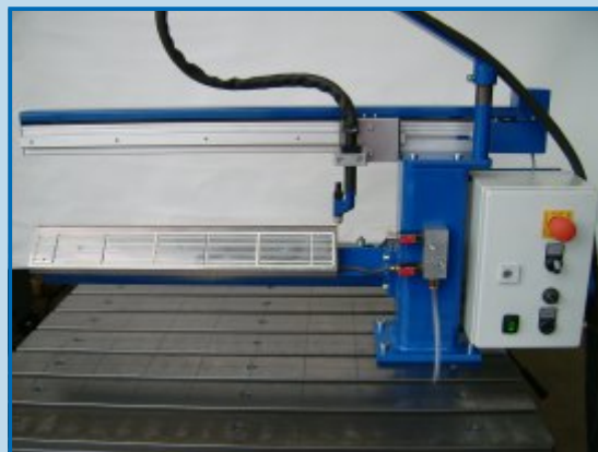
saldatura di giunti angolari su trave vuota
