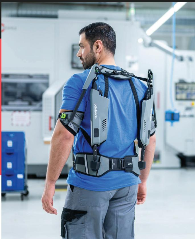
SUITX Shoulder è un esoscheletro passivo che sostiene le persone che svolgono quotidianamente compiti con le braccia alzate. Ad esempio allevia lo sforzo sulle articolazioni delle spalle e sulla parte superiore delle braccia, durante i lavori sulle linee di montaggio, o in attività di edilizia e manutenzione.
