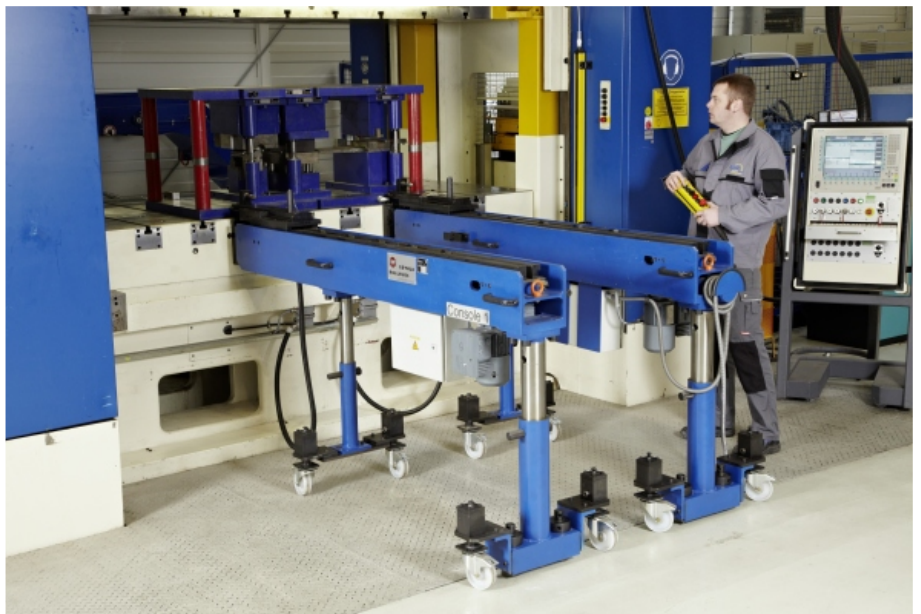
Cambio utensile semplice e in pochissimi minuti
