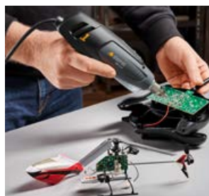
Saldatura di componenti elettrici
