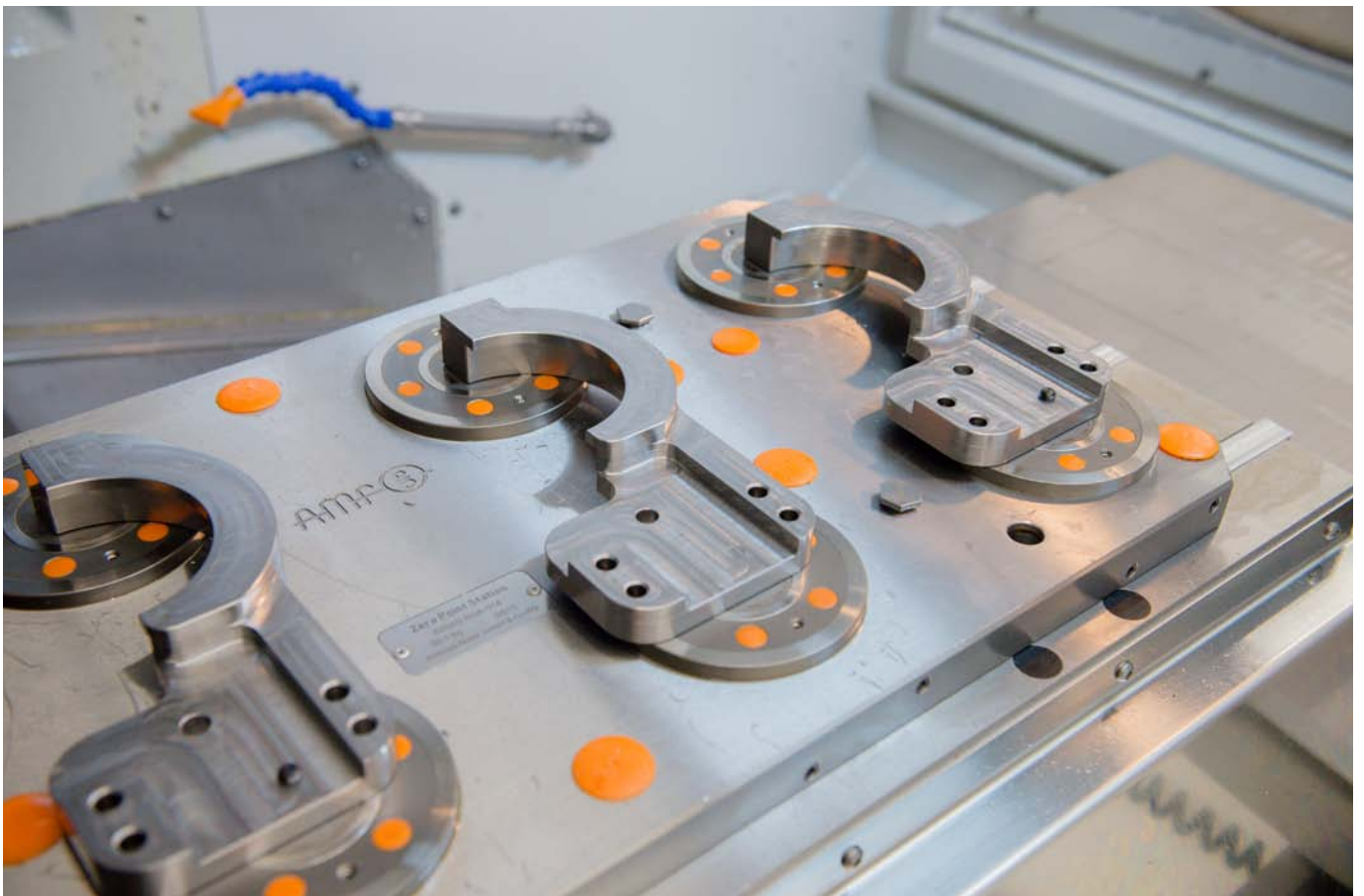
Stazione di tensionamento a 8 posti per l'alloggiamento di diversi attrezzi di serraggio standard o serraggio diretto del pezzo da lavorare.
