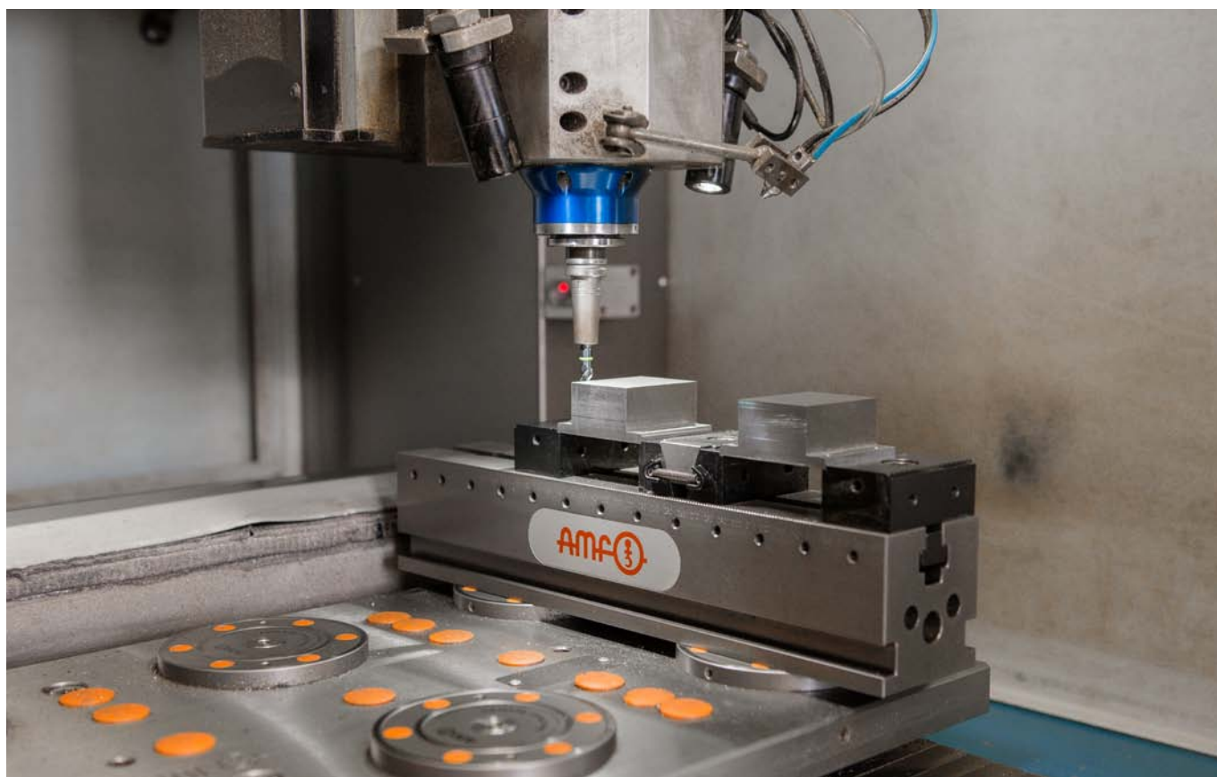
Il sistema di bloccaggio multiplo AMF in combinazione con il Zero-Point-Systems AMF
