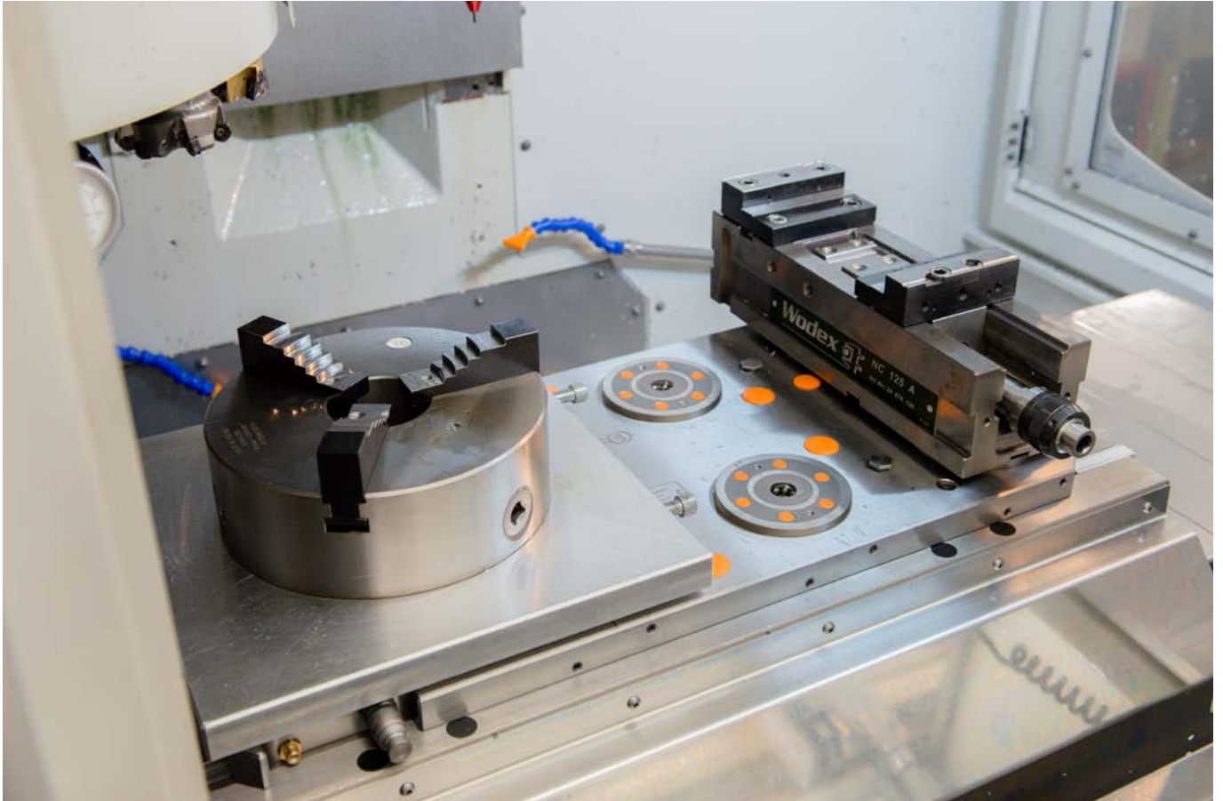
Stazione di tensionamento a 8 posti per l'alloggiamento di diversi attrezzi di serraggio standard o serraggio diretto del pezzo da lavorare.
