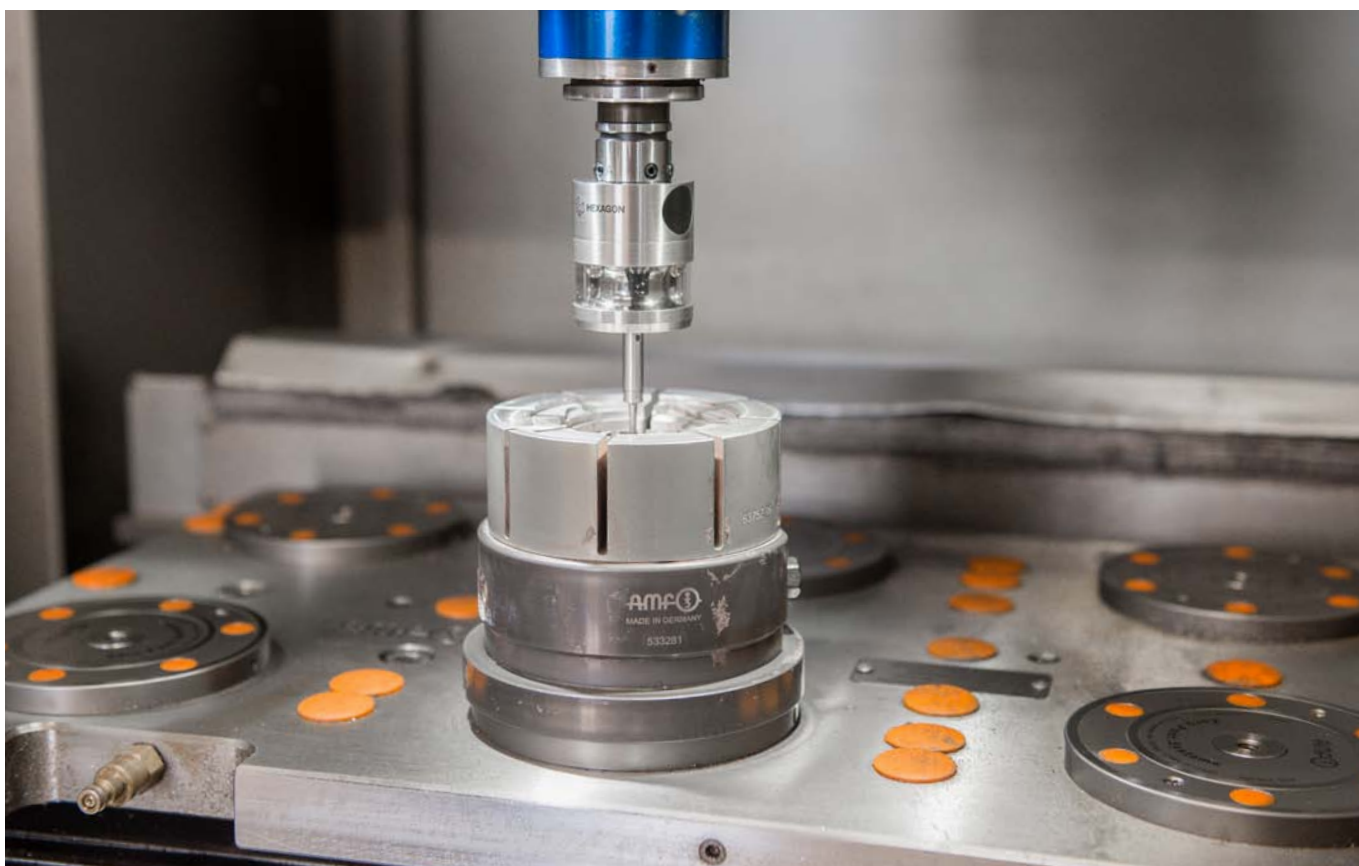
La pinza di serraggio meccanica viene serrata direttamente tramite tecnica di bloccaggio punto zero. Ottimale per bloccare pezzi delicati o a parete sottile con bordo esterno complesso.
