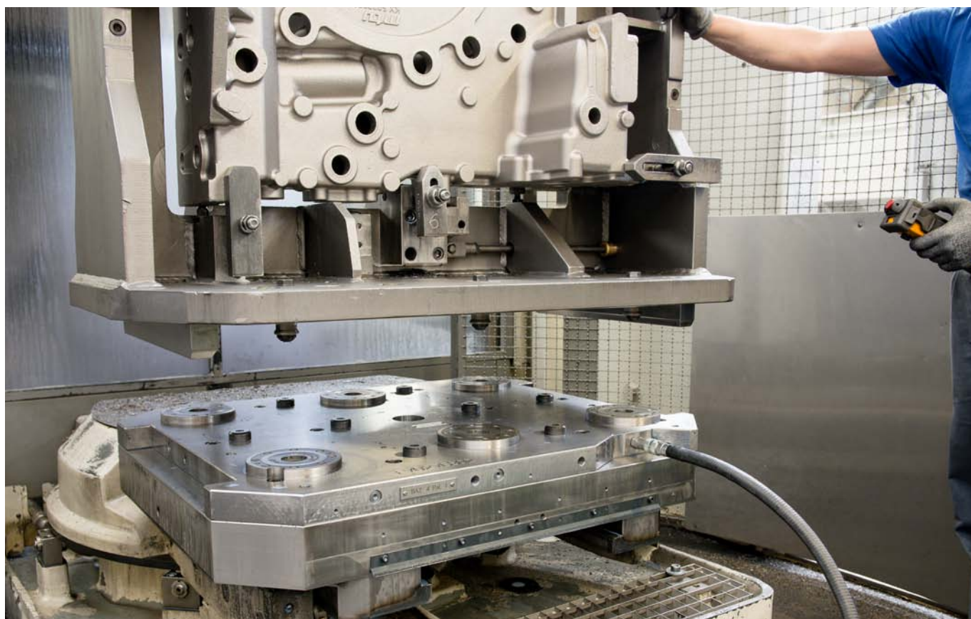
Grazie al sistema del bullone di serraggio diviso in due, con grande tolleranza di inserzione e struttura del modulo senza gabbia per sfere, è possibile un cambio ergonomico del dispositivo senza inclinazione.
