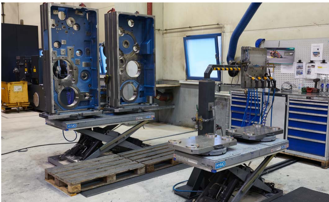
Piattaforme elevatrici a forbice dotate di tecnologia di bloccaggio a punto zero per la sbavatura dei pezzi. In questo modo, l'intero processo di produzione è stato completamente ottimizzato con il sistema Zero-Point AMF.
