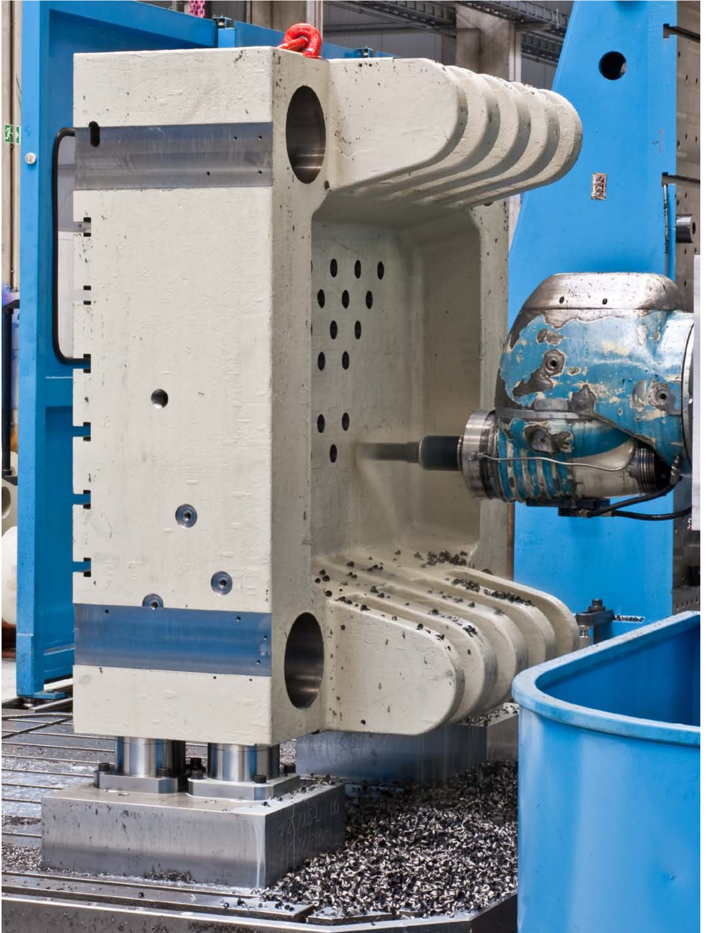
Console di tensionamento punto zero in utilizzo con asportazione del truciolo difficile.
