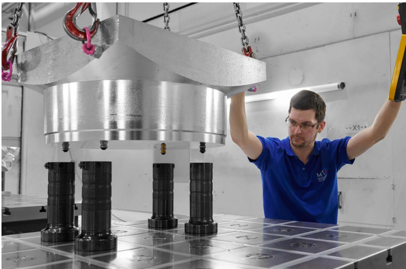
Tempi di allestimento ridotti al minimo tramite tecnica di bloccaggio punto zero AMF: il pezzo è bloccato per la lavorazione su cinque lati con pochi interventi.
