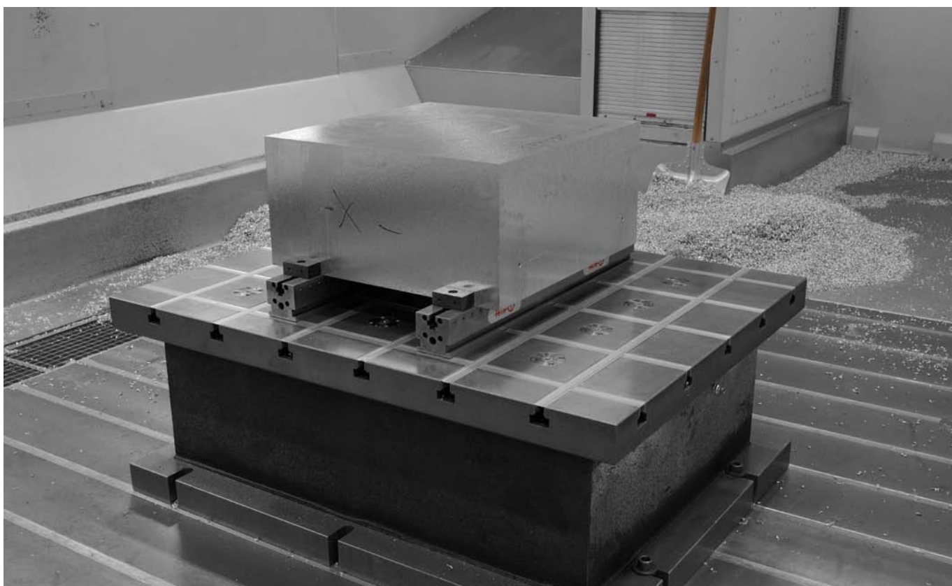
Il sistema di bloccaggio punto zero di AMF consente la massima flessibilità. Il sistema di bloccaggio multiplo AMF può essere bloccato molto facilmente tramite tecnica di bloccaggio punto zero e quindi integrato nel processo di produzione.
