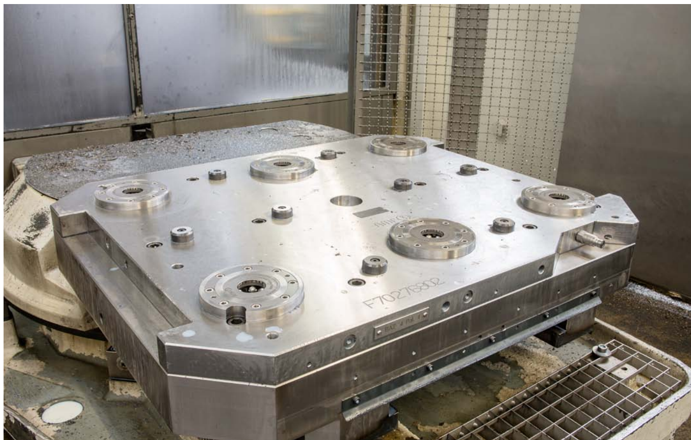
Tecnica di bloccaggio punto zero utilizzata nella produzione di grandi motori. Efficienza grazie all'attrezzaggio in parallelo di dispositivi di serraggio meccanici.
