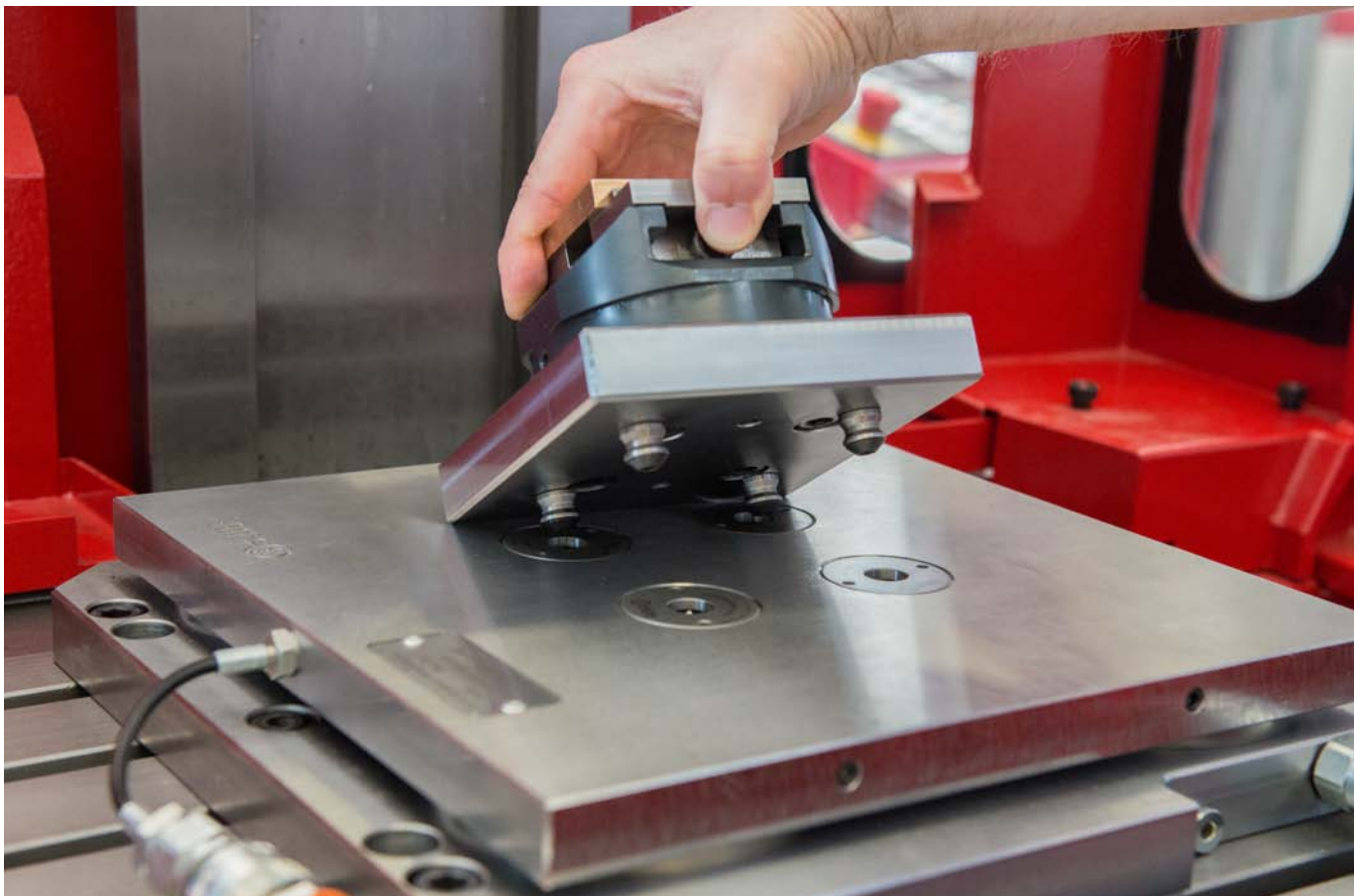
Utilizzo di diverse dimensioni di moduli di serraggio standard in un'unica applicazione.
