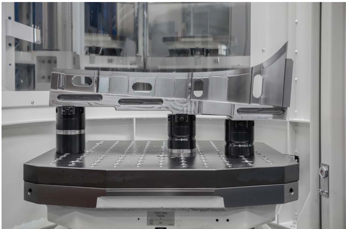
Sistema di serraggio meccanico punto zero modulare nella creazione di utensili e stampi. Le differenti altezze di bloccaggio necessarie possono essere adattate facilmente tramite il sistema modulare standardizzato.
