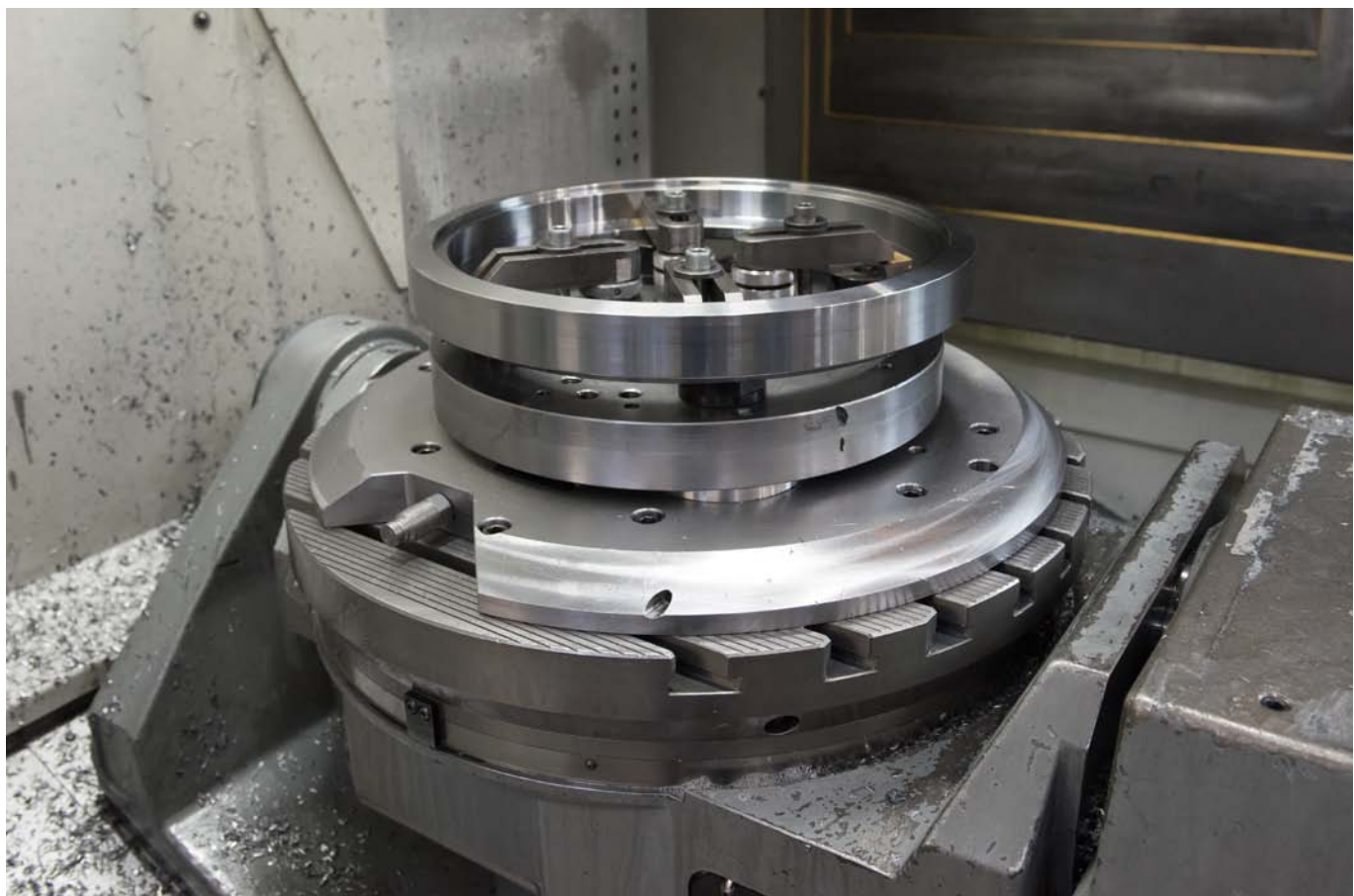
Lavorazione a 5 assi di componenti di ingegneria meccanica. Stazione di tensionamento quadrupla con contorno esterno individuale per la massima accessibilità.
