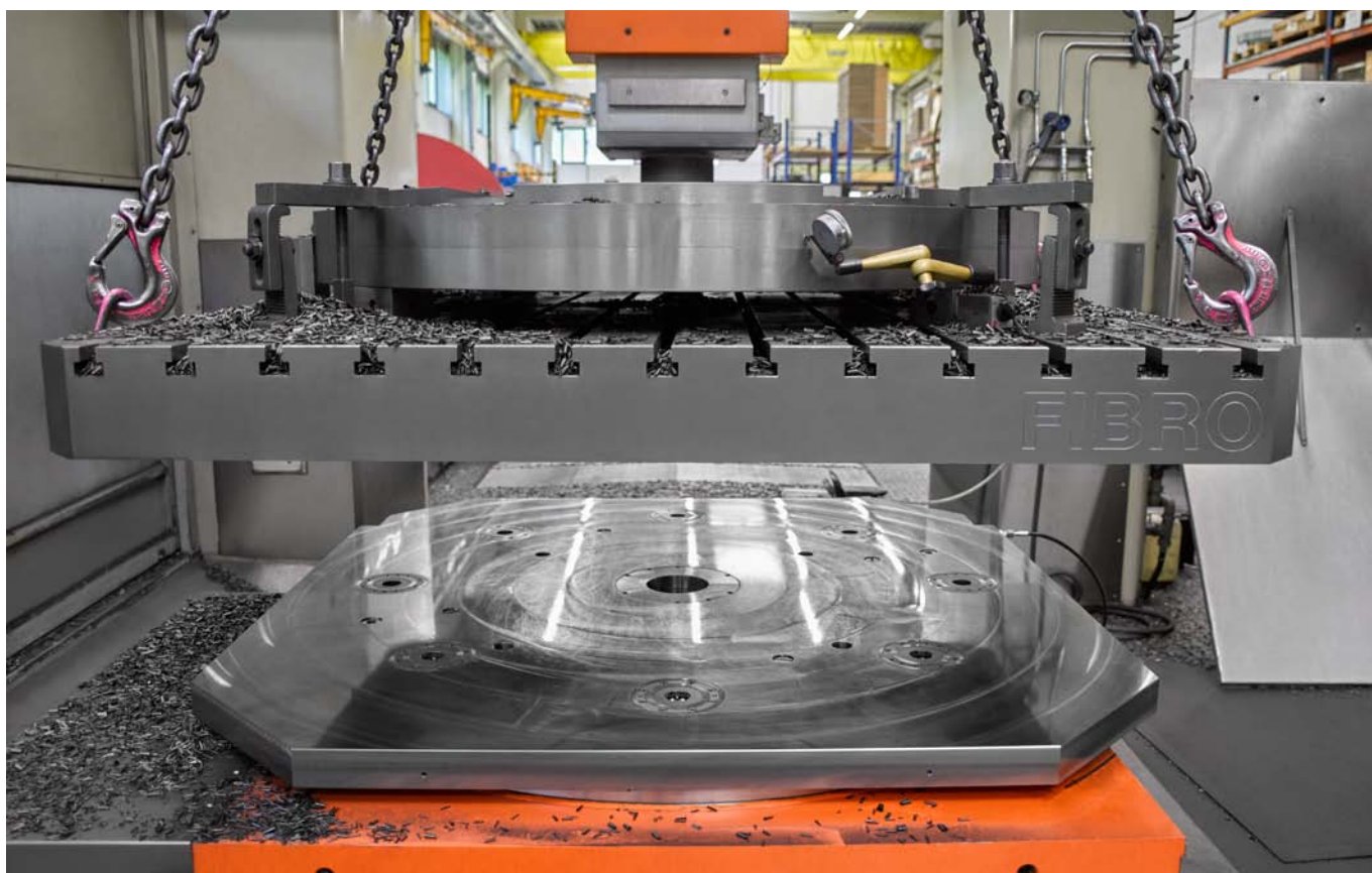
Moduli di serraggio integrati sul lato superiore e inferiore in una tavola di indessaggio rotante. I tempi di allestimento sono stati ridotti da molte ore a pochi minuti ed aumenta al massimo la flessibilità dell'intera macchina.
