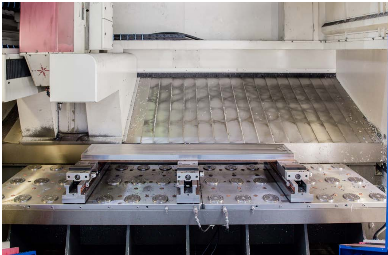
Allineamento semplice di molteplici morse durante la lavorazione di pezzi lunghi.
