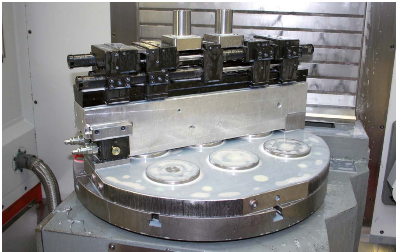
Morsa idraulica per la lavorazione di diversi pezzi in un unico serraggio – serrato sul Zero-Point-System AMF.
