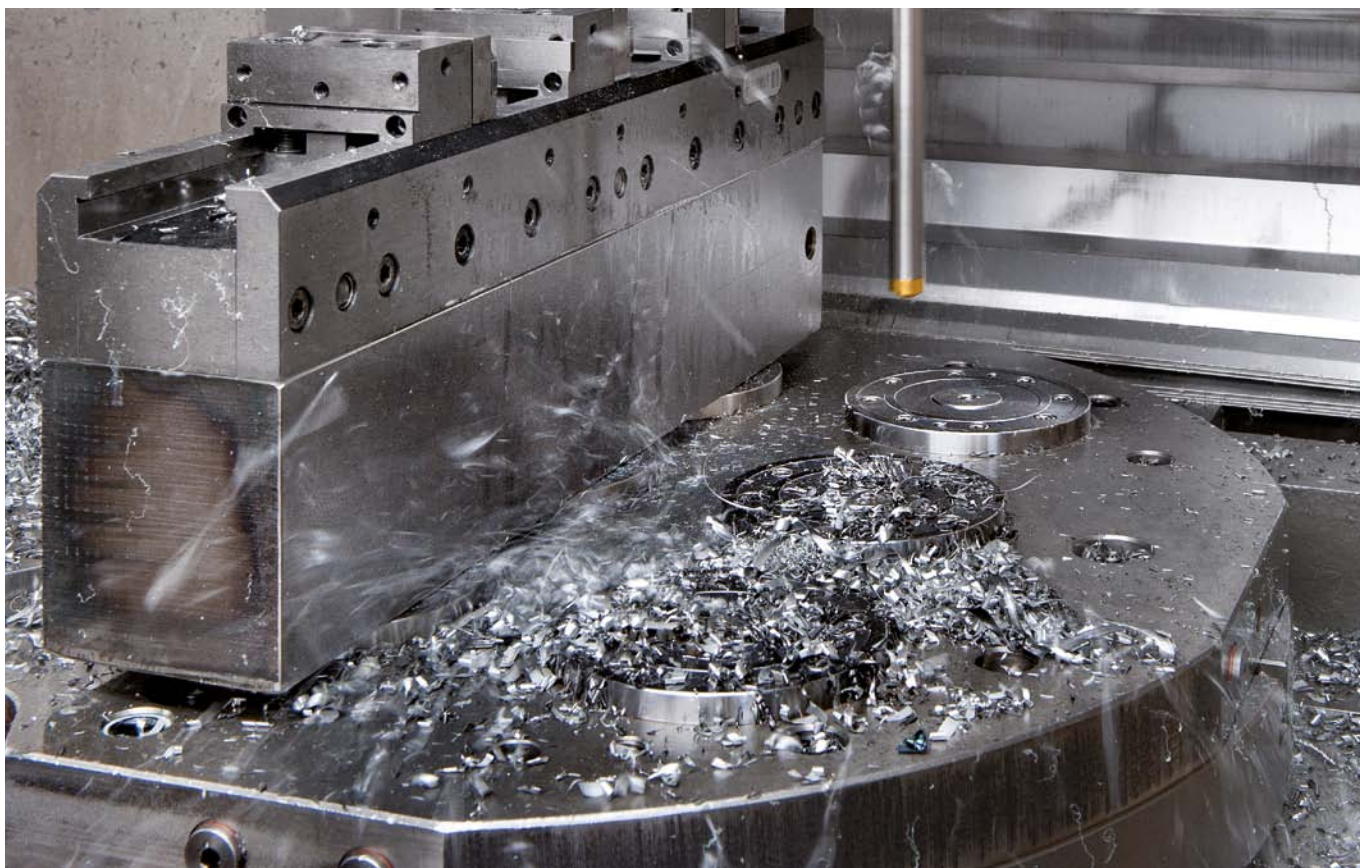
Clean stick AMF in utilizzo: pulizia automatizzata del dispositivo di serraggio e del tavolo macchina.
