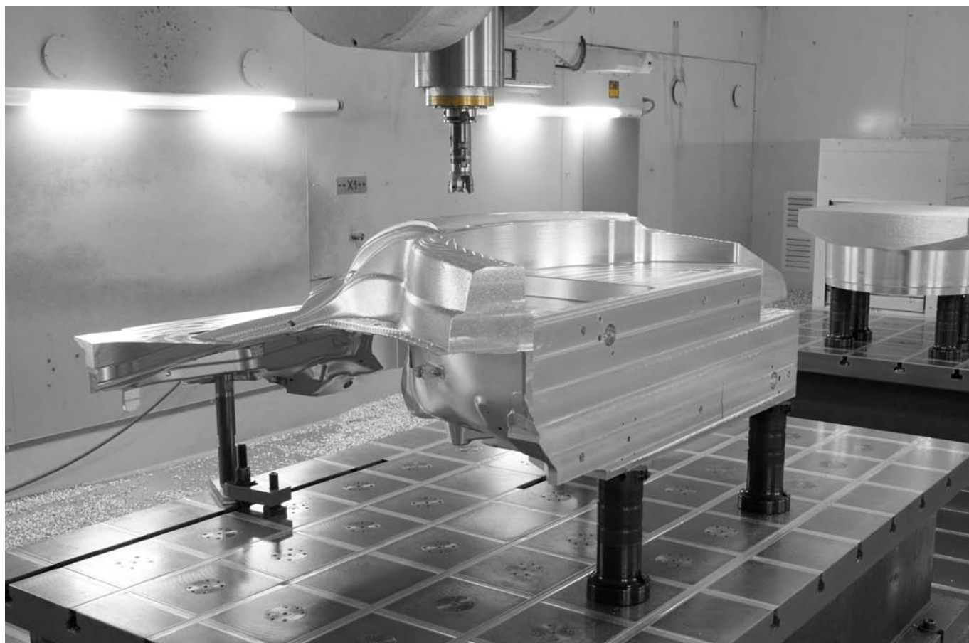
Serraggio diretto dei pezzi in alluminio di grandi dimensioni. Moduli di bloccaggio a punto zero nella tavola di fissaggio in combinazione con elementi di montaggio e intermedi del sistema di bloccaggio punto zero consentono un bloccaggio flessibile.
