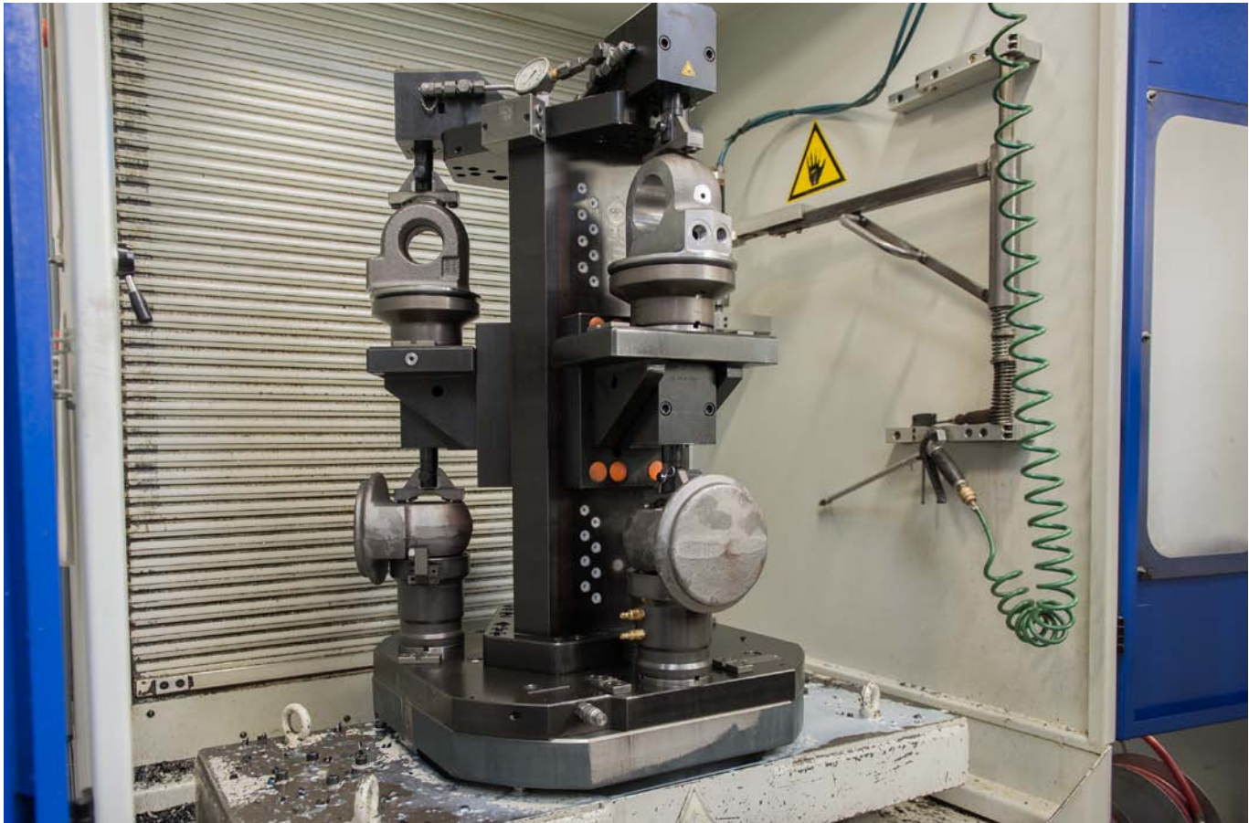
In questa soluzione di serraggio completa, diversi tipi di serraggio sono combinati in un unico dispositivo di serraggio. (sistema di serraggio modulare, tecnica di bloccaggio idraulica nonché tecnica di bloccaggio punto zero).
